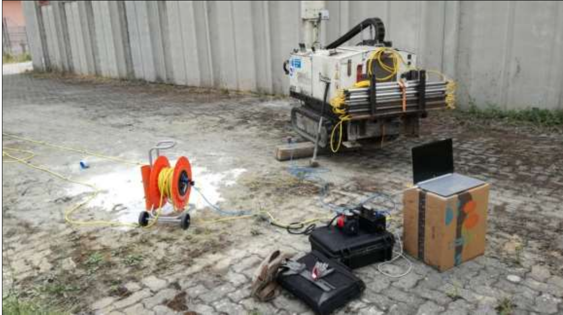
Figura 10.5. Esecuzione prova sismica Down Hole
