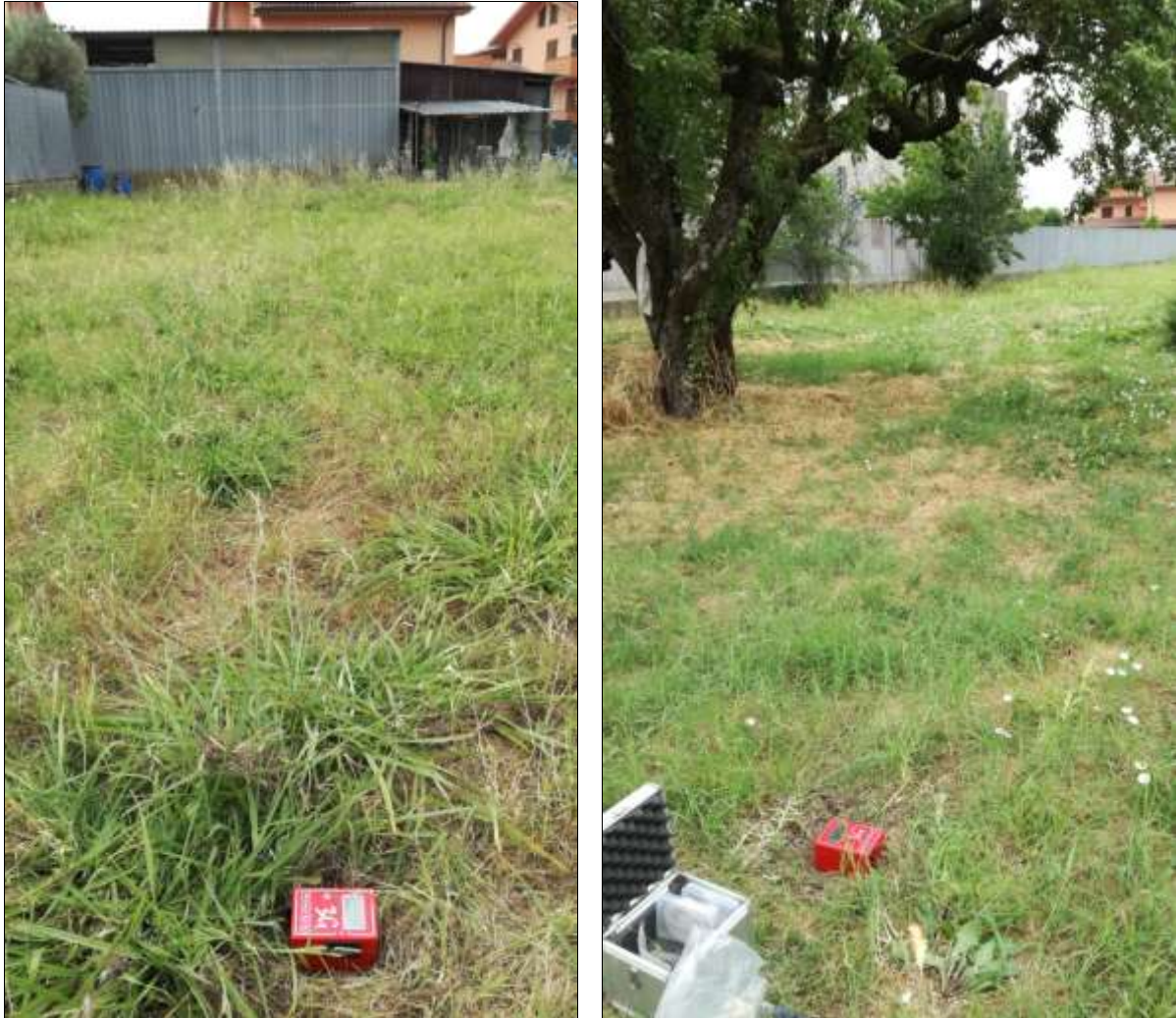
Figura 10.4. Esecuzione prove sismiche: HVSR 1 (sinistra) e HVSR 2 (destra)
